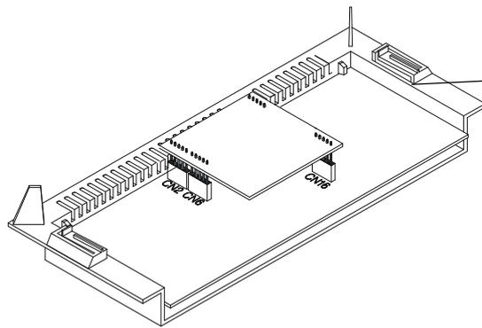
Encaixe a Placa de Comunicação Modulare nos conectores CN1, CN4, CN5, CN7, CN11 e CN12.
