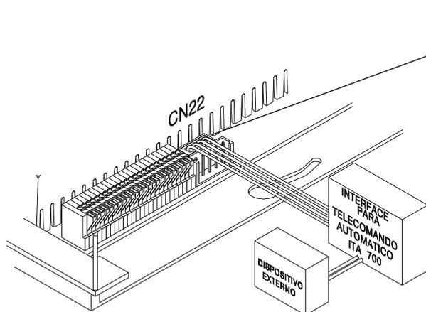
Para que a Chamada de Emergência seja acionada por um dispositivo externo com chave de contato normalmente aberto, conecte-os à Interface de Atuação Externa ITA 700 no CN22 da placa base e interligue os contatos da chave em SALMA e SALMB.
