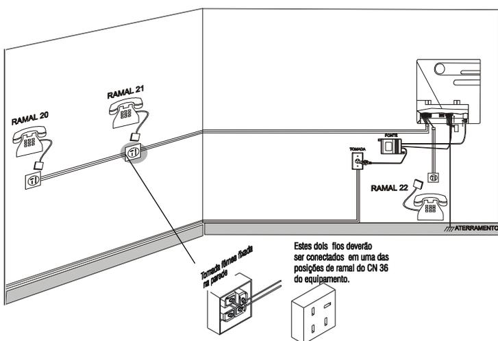
Neste caso, você precisará conectar o par de fios de cada ramal em tomadas padrão Telebras, conectar os telefones a estas tomadas e logo em seguida levar a fiação através de canaletas (utilize canaleta perfil PVC 2200x10x20) até o local onde está instalada a Central.
