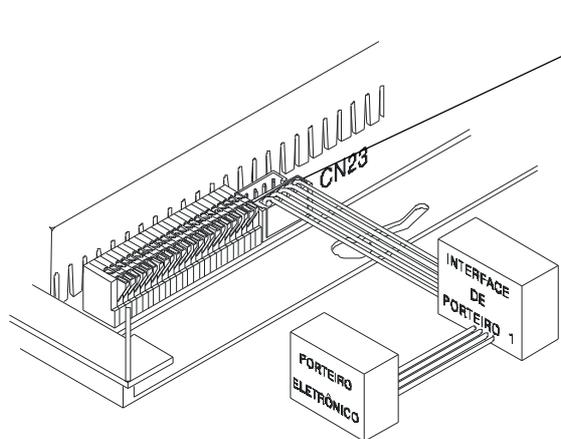
Instale a Interface de Porteiro no conector CN23 da placa base.
