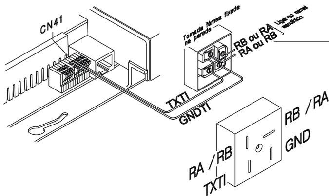
A conexão do Terminal à Central é feita a quatro fios, dois para áudio (RA/RB) e dois usando-se a Placa de Comunicação Modulare para transmissão de dados (TXTI/GNDTI). Não é necessária nenhuma programação no PABX e qualquer ramal poderá receber um Terminal.
