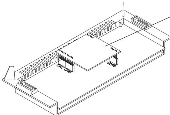
Desligue a central antes de instalar a placa e não toque nos componentes da placa; Isto pode danificar os componentes eletrônicos.
